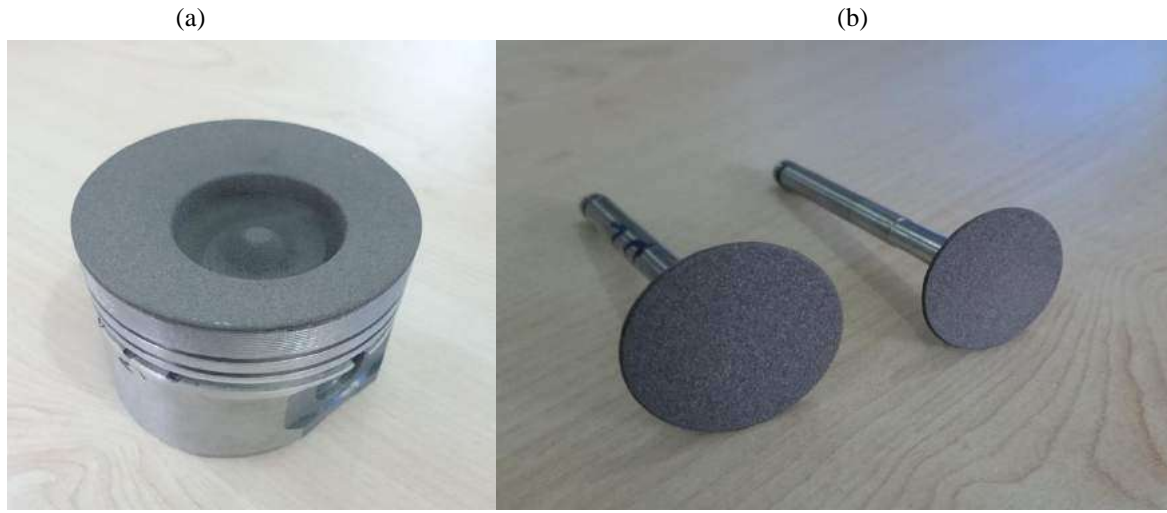
Cr_2O_3 kaplanmış piston (a) ve supaplar (b)
