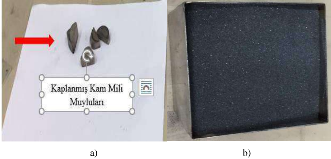
Şekil 2.1. (a) Borlama öncesi kam mili muyluları (b) Borlama işlemi hazırlık süreci
